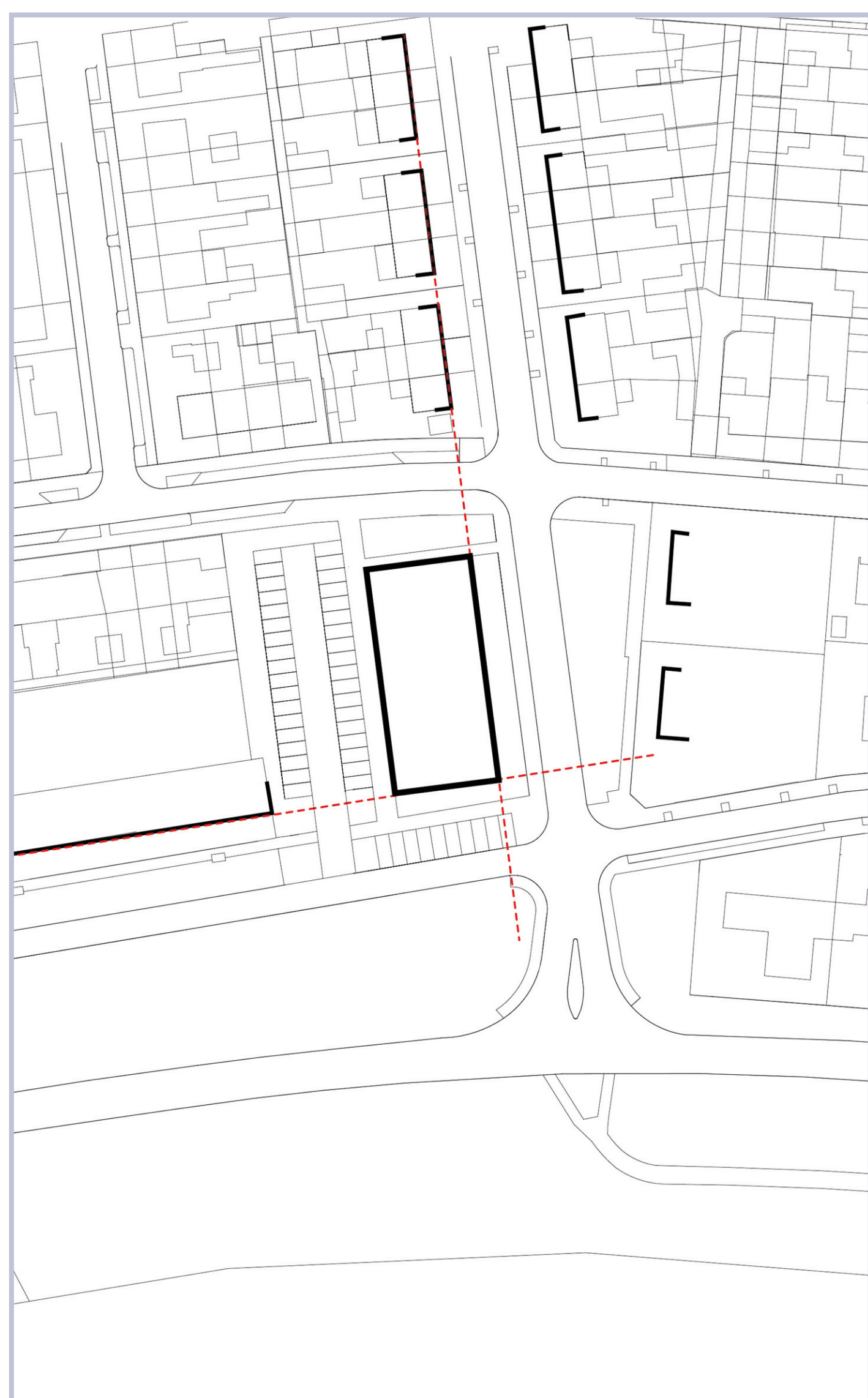
Rooilijnen bestaande structuur
