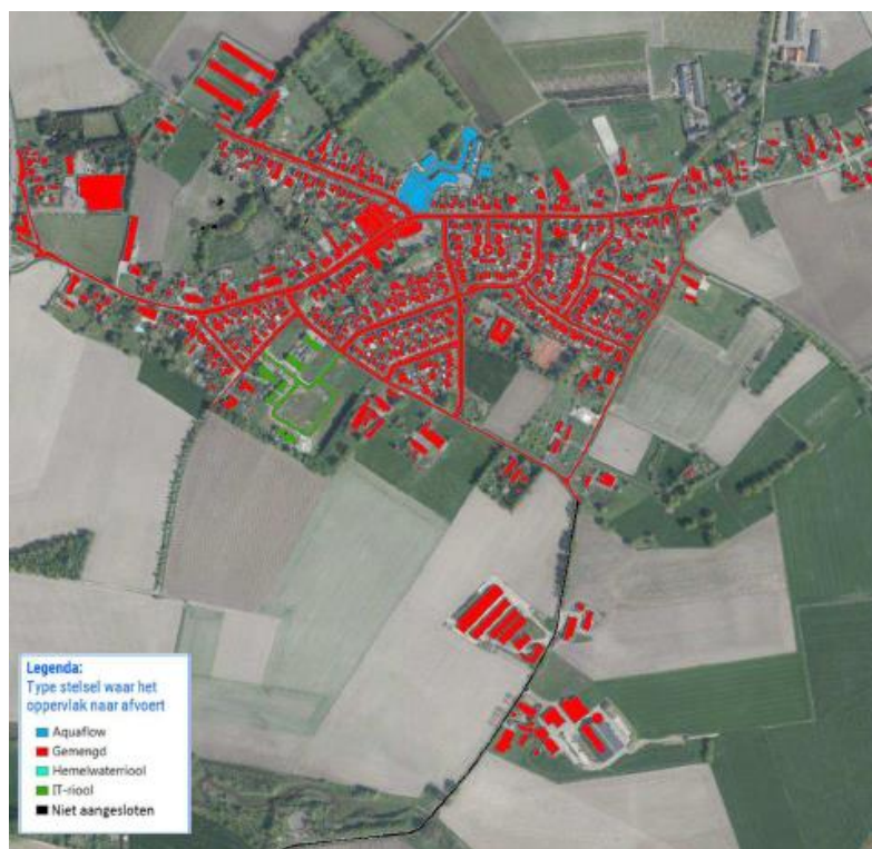
Figuur 7.7: Type stelsel afvoer oppervlak Tungelroy
